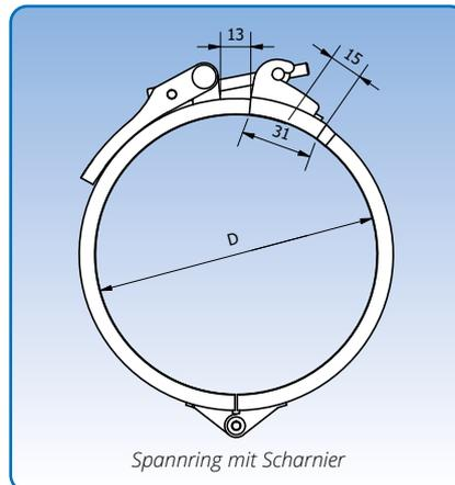
Von  $\varnothing$  80 mm bis 125 mm mit verstellbarem Hebel und Scharnier.
