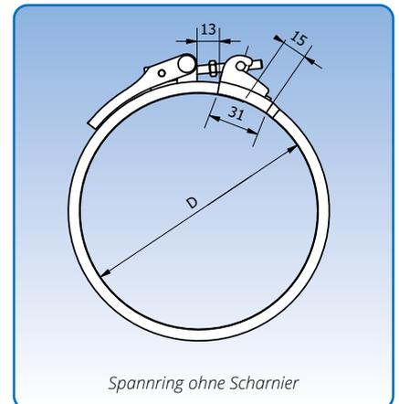
Von  $\varnothing$  140 mm bis 500 mm mit verstellbarem Hebel, ohne Scharnier.
