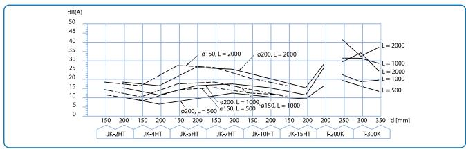
Im Diagramm sind die Dämpfungswerte in dB (A) für Ventilatoren bzw. Gebläse dargestellt.
