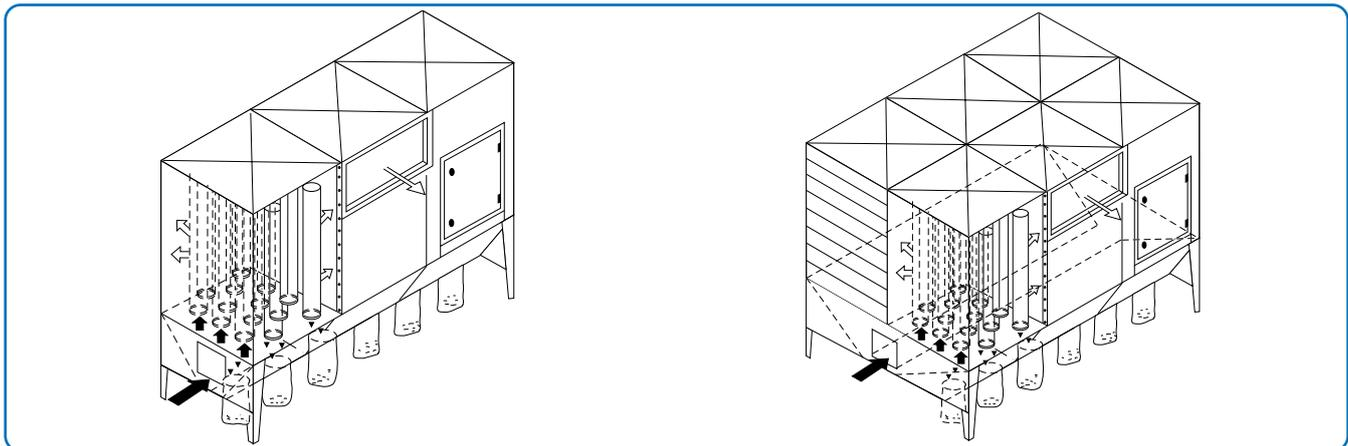
Absackfilter Typ LS und Doppelabsackfilter Typ LSD.
